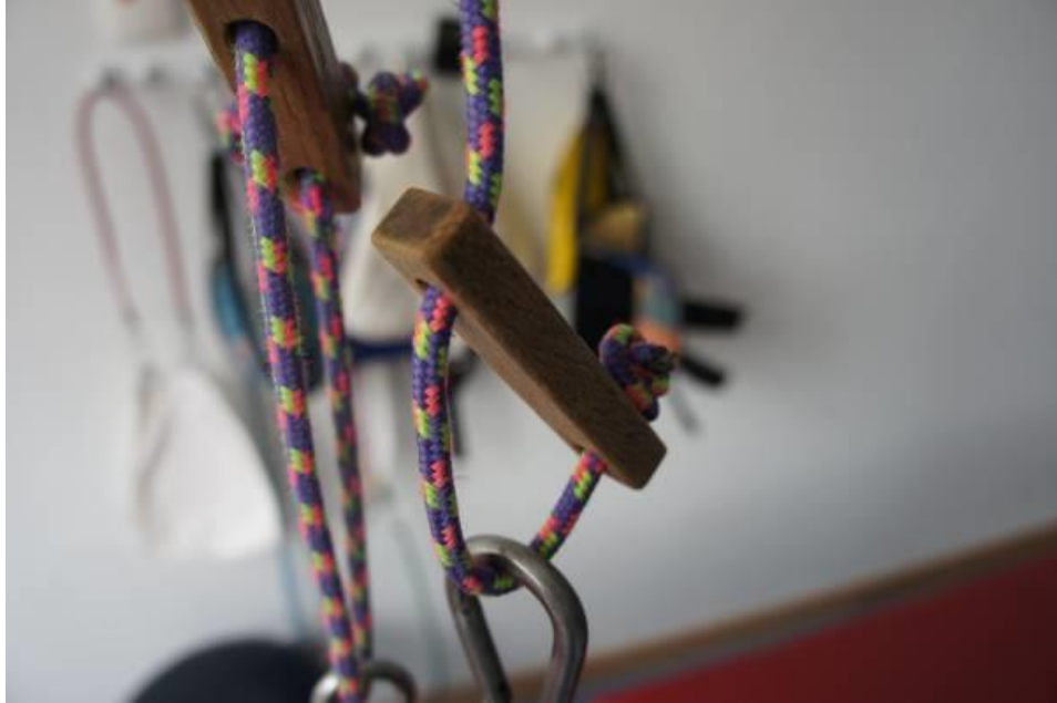
Bild 6: Höhenverstellung durch ein Holzstück
