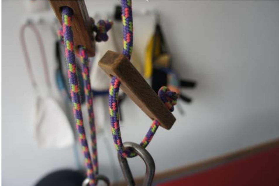
Bild 6: Höhenverstellung durch ein Holzstück
